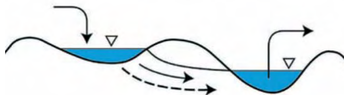
Figura 2.10 Duna de infiltración
