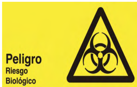
Fig.40. Señal Seguridad Peligro Riesgo Biológico.
