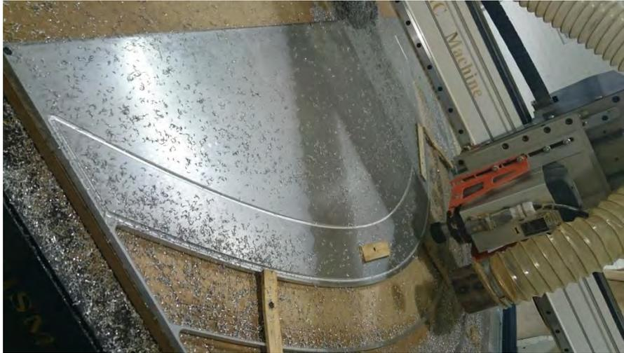
**Figura 4.4 Router CNC cortando la placa de aluminio.**
