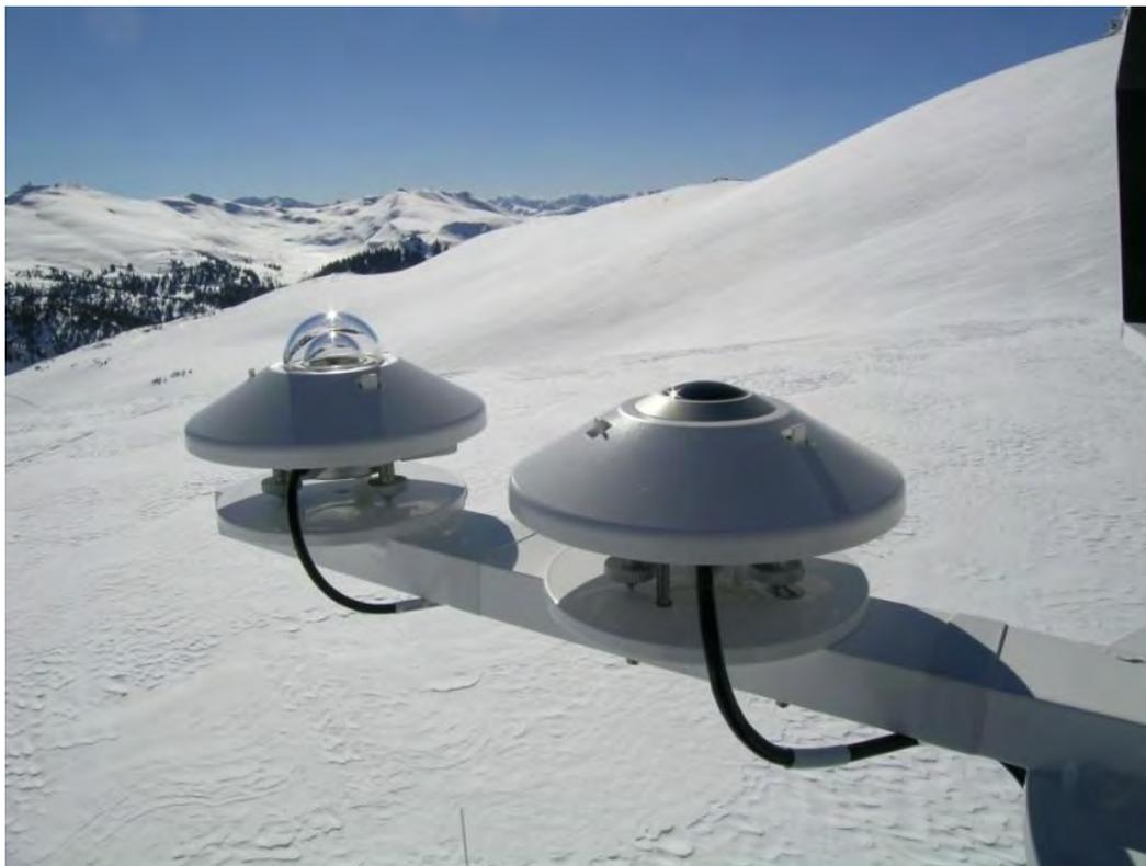
**Figura 1.5. Piranómetro para radiación global (derecha) Piranómetro para radiación difusa (izquierda)**
