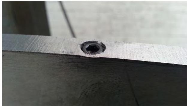
**Figura 4.6 Tornillo allen para el acoplamiento de las barras de aluminio.**
