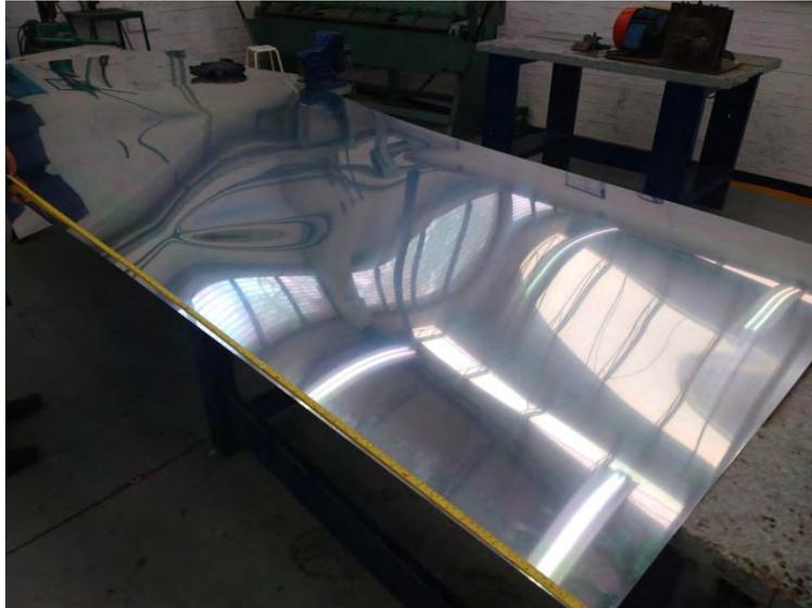
**Figura 4.7. Hoja de aluminio súper pulido antes de ser cortada en una cizalla.**
