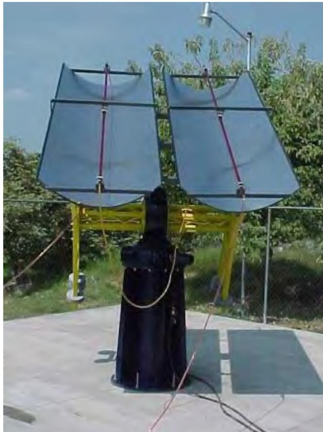
Figura 2.9. Colectores cilindrico-parabólicos del CIE UNAM.
