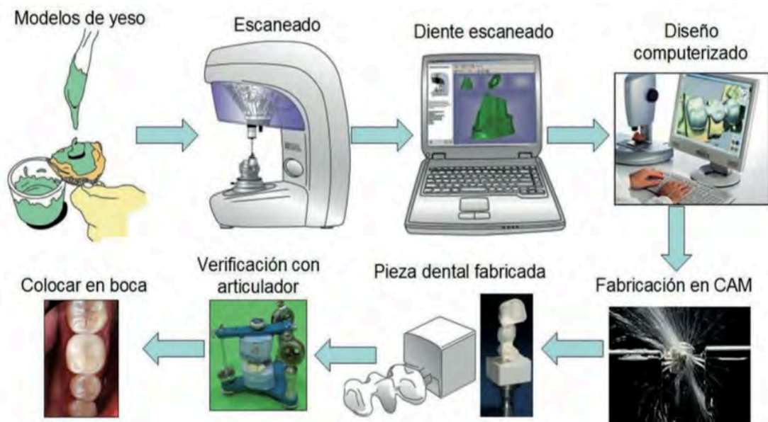
Figura 3 Proceso en un sistema CAD-CAM.
