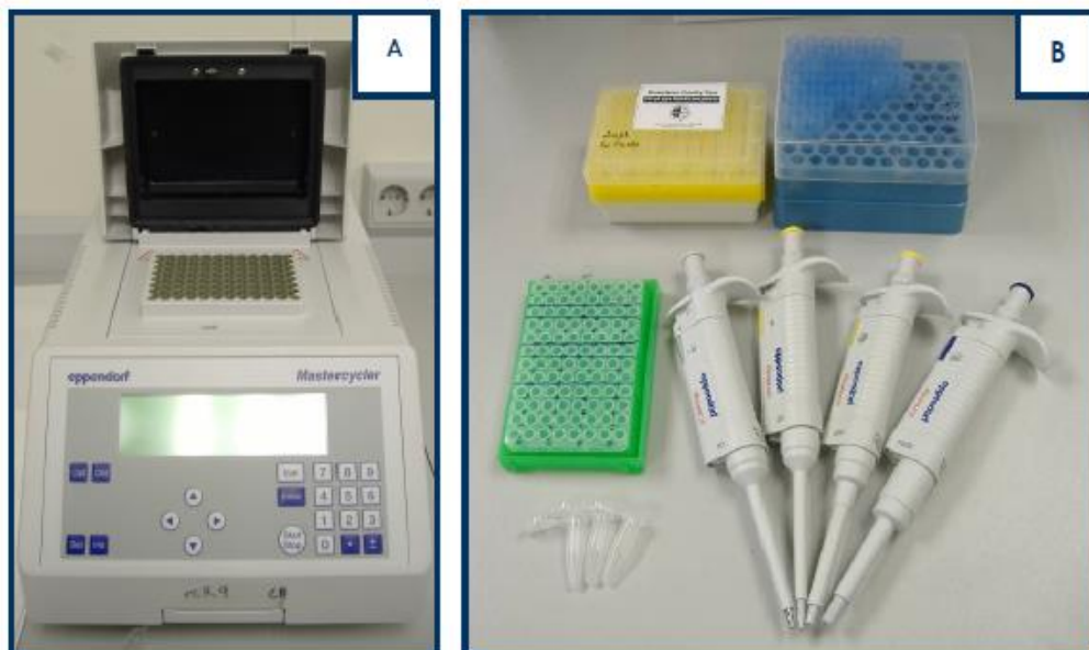
Figura 23. Equipo y materiales para llevar a cabo una PCR: A. Termociclador. B. Puntas, placa de PCR, microtubos y juego de micropipetas. 47
