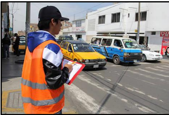
Figura 5.10. Ejemplo de un Aforo Vehicular. En la imagen izquierda, aforo manual; en la derecha, aforo por método radar-sistema de video.
