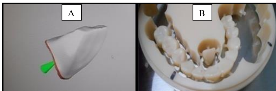
Figura 53 (A) Diseño listo para fresar, (B) Obtención de la corona. Fuente directa
