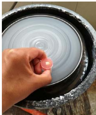
Figura 5. Desgaste de coronas con papel de carburo de silicio de grano 180. F.D
