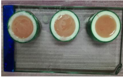
Figura 3 y 4. Acrílico vertido dentro de los anillos de pvc. F.D.
