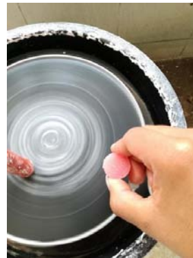
Figura 6. Desgaste de coronas con papel de carburo de silicio de grano 600 . F.D.
