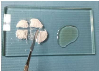
Figura 10. Incorporación del polvo al líquido. F.D.
