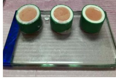
Figura 3 y 4. Acrílico vertido dentro de los anillos de pvc. F.D.
