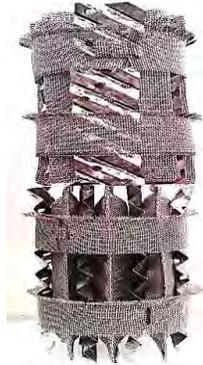
**Figura 24.** Vista lateral del lecho empacado en el interior de la CDR.
