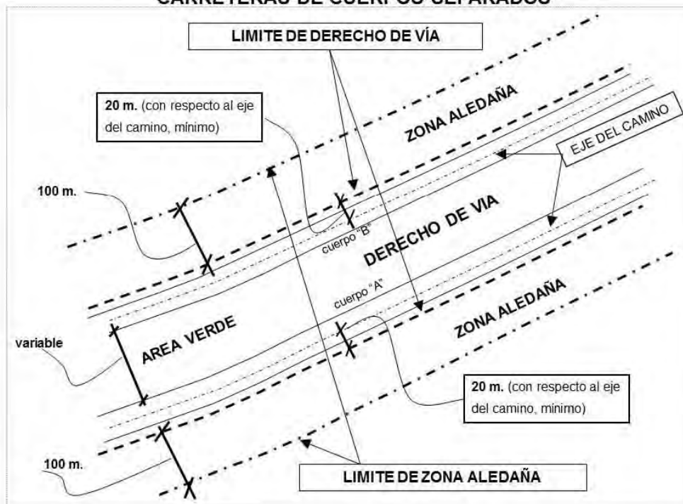
FIGURA No. 2: DERECHO DE VÍA Y ZONA ALEDAÑA EN CARRETERAS DE CUERPOS SEPARADOS
