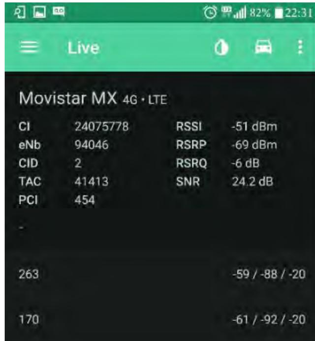
Figura 4.18 Mediciones de LTE usando la aplicación NetMonster.
