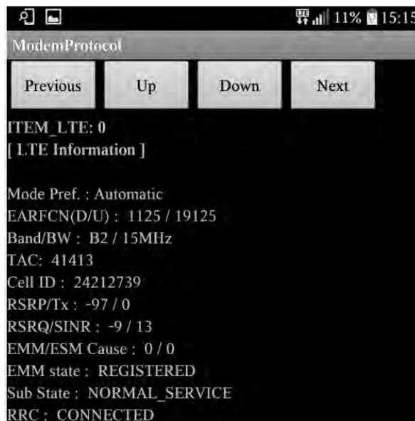
Figura 4.17 Resultados en LTE en modo “Field Test”
