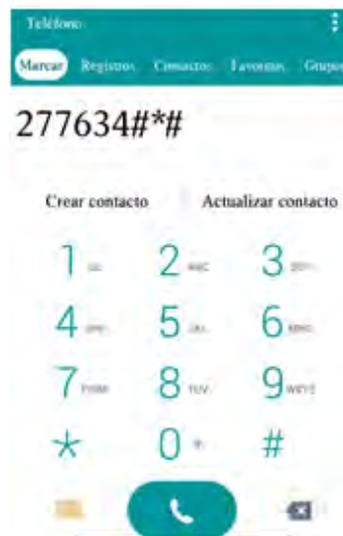
Figura 4.15 Código acceso a Field Test mode LG G3- D852
