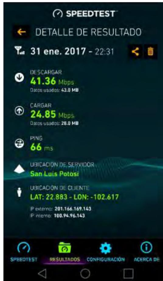
Figura 4.19 Prueba de throughput del enlace descendente y ascendente en LTE.
