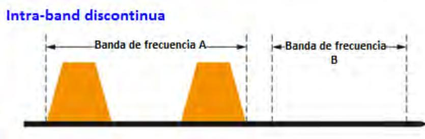
Figura 3.5 Configuración Carrier Aggregation intra-band discontinua.
