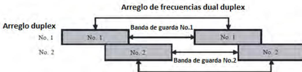
Figura 2.3 Separación dual dúplex en FDD. [2]
