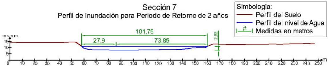
Ilustración 71.- Perfil de inundación para periodo de retorno de 2 años en la sección 7.
