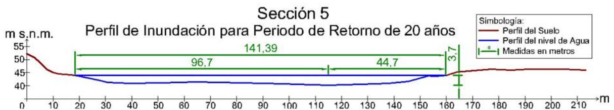
Ilustración 60.- Perfil de inundación para periodo de retorno de 20 años en la sección 5.
