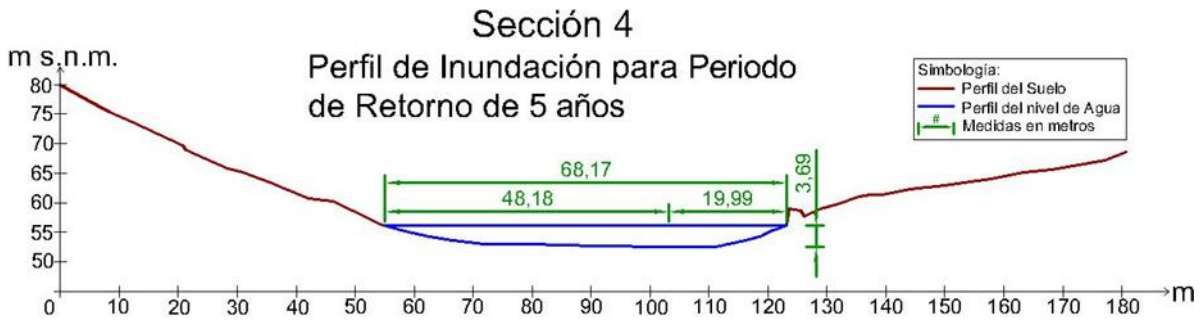
Ilustración 51.- Perfil de inundación para periodo de retorno de 5 años en la sección 4.
