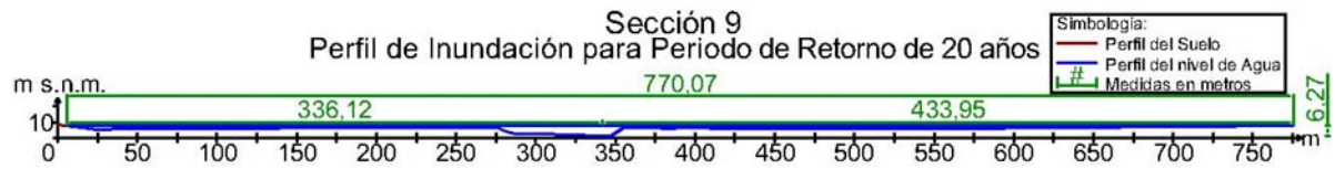
Ilustración 88.- Perfil de inundación para periodo de retorno de 20 años en la sección 9.
