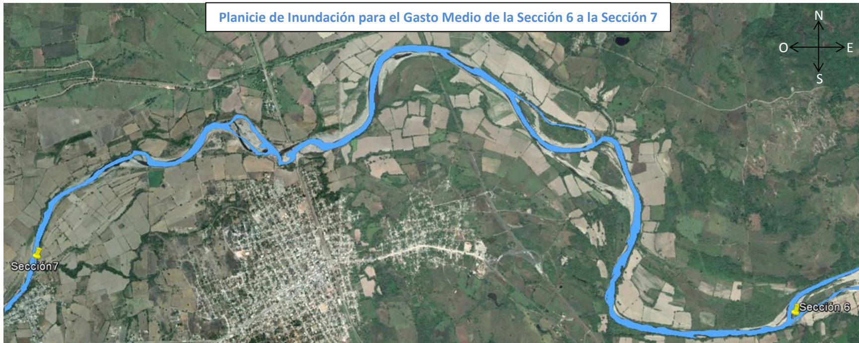
Ilustración 96.- Planicie de inundación para gasto medio, sección 6 a sección 7.
