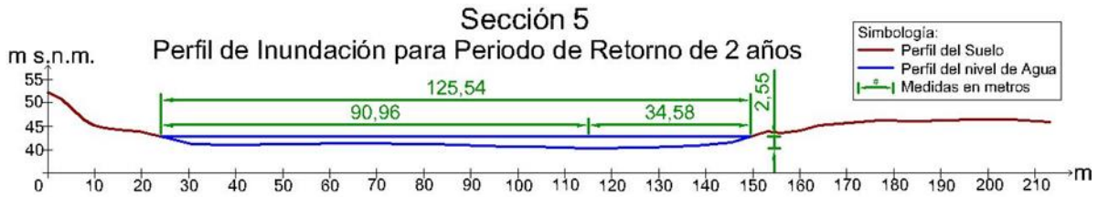
Ilustración 57.- Perfil de inundación para periodo de retorno de 2 años en la sección 5.
