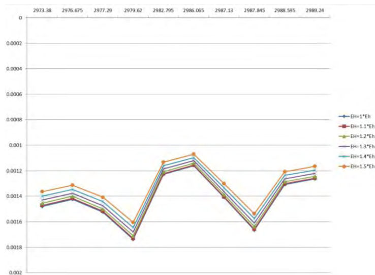
Figura 4. 2 Gráfica de la deformación horizontal máxima vs profundidad, Batial 1
