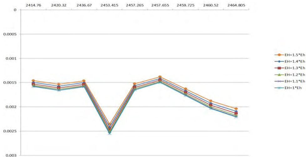
Figura 4.18 Gráfica de la deformación horizontal máxima vs profundidad, Mosquete 1
