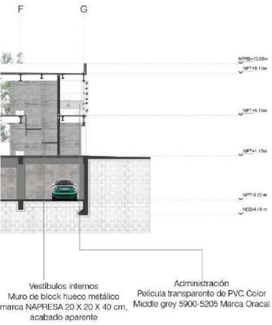
Corte Transversal 2-2', criterio de acabados
