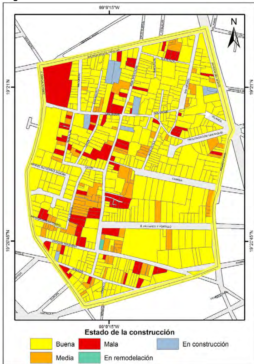
Figura 3.18 Estado de la Construcción Barrio de San Lucas
