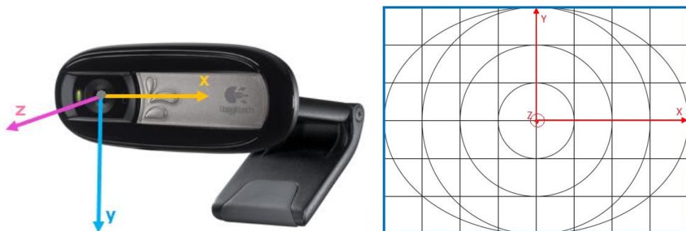
Ilustración 37 Marco coordenado de la webcam y malla de calibración de ReactIVision
