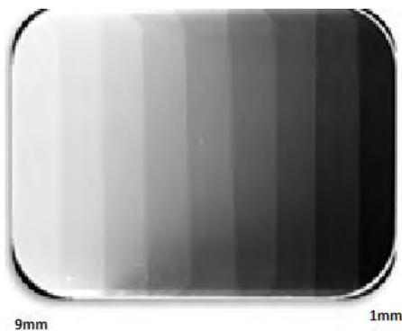
Figura 3.3. Testigo calibrado de aluminio escalonado de 1 a 9 mm de espesor.
