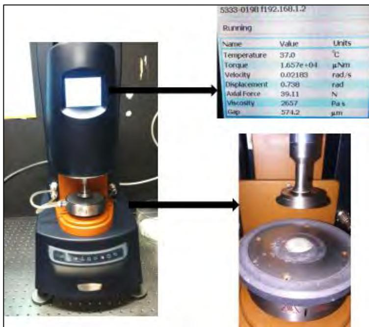
Figura 3.4. Reómetro DISCOVERY- HR-3 y muestra del cemento de MTA y NCs de FeS<sub>2</sub>.
