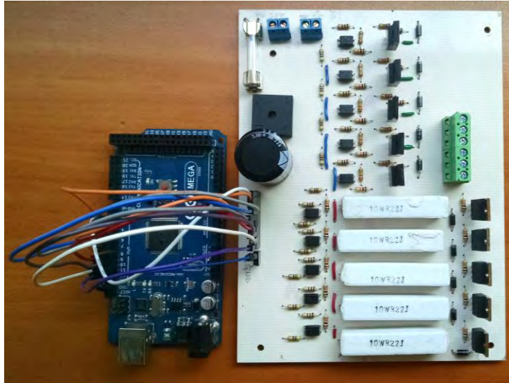
Fig. 2.12 Conexión del circuito con una tarjeta de desarrollo Arduino MEGA para pruebas.
