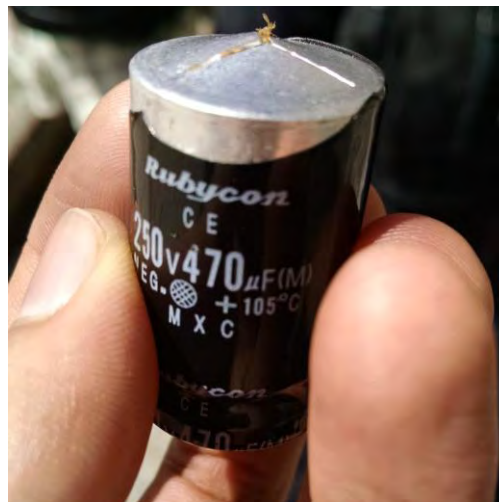
Fig. 2.13 Destrucción del capacitor.
