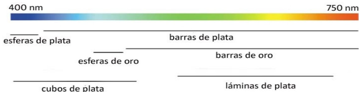
Figura 2.6: Localización de diferentes morfologías típicas de nanopartículas de plata y oro en el espectro de luz según la absorción provocada por la resonancia del plasmón superficial.
