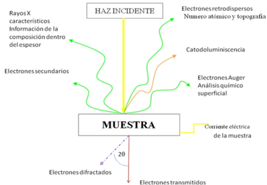
Figura 2.15: Diferentes dispersiones que sufre el haz de electrones al interactuar con la muestra.
