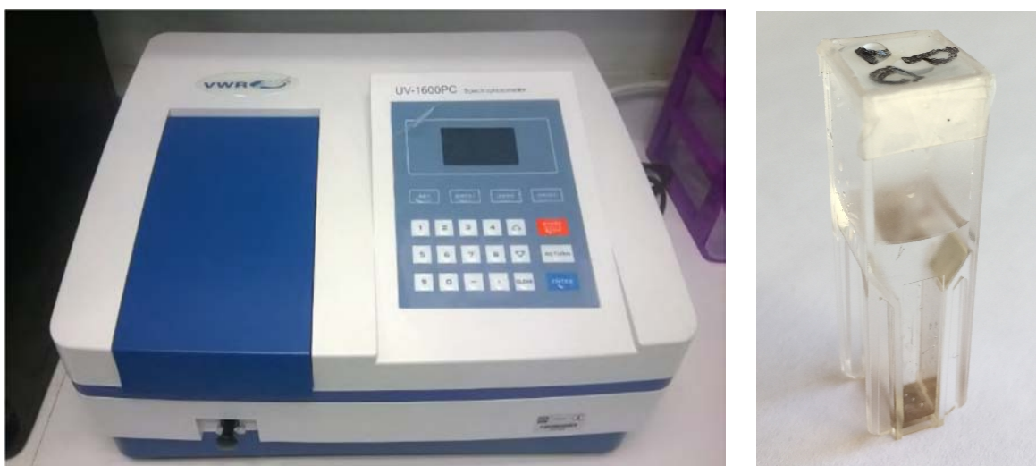
Figura 2.7: a) Izquierda, espectrofotómetro UV-1600PC marca VWR localizado en el CFATA; b) derecha, celda para líquidos de acrílico para UV-Vis.
