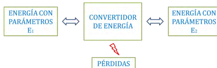
FIGURA 4.1.1 ESTRUCTURA BÁSICA DE UN CONVERTIDOR.. REGULACIÓN, CONTROL Y PROTECCIÓN DE MÁQUINAS ELÉCTRICAS APUNTES DE LA ASIGNATURA CONVERTIDORES ELECTRÓNICOS DE POTENCIA DEPARTAMENTO DE INGENIERÍA ELÉCTRICA Y ENERGÉTICA UNIVERSIDAD DE CANTABRIA
