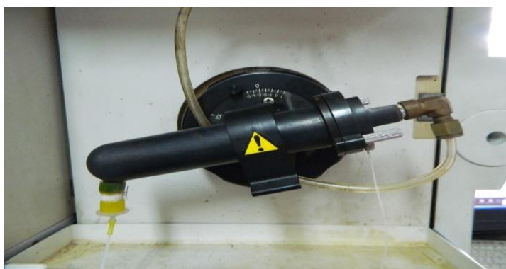
Figura 4.6- Nebulizador de flujo cruzado con inyectores de zafiro y rubí del equipo ICP-OES.
