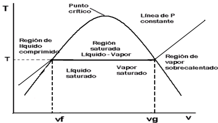
Figura 1.6.1 Diagrama T-V se pueden apreciar inicialmente tres regiones: la región de líquido comprimido, (a la izquierda de la campana), región de vapor sobrecalentado (a la derecha de la campana) y la región de Líquido + Vapor saturados (dentro de la campana), marcado por una línea de presión constante. [5]
