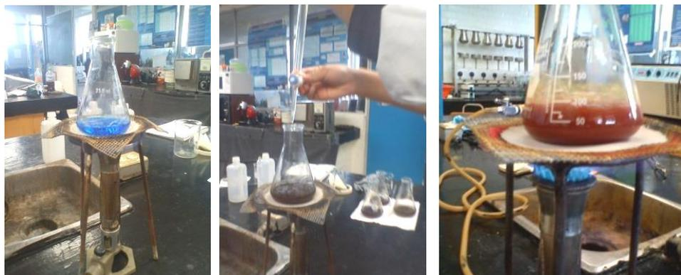
**Figura 46.** Titulación muestras para carbohidratos.
