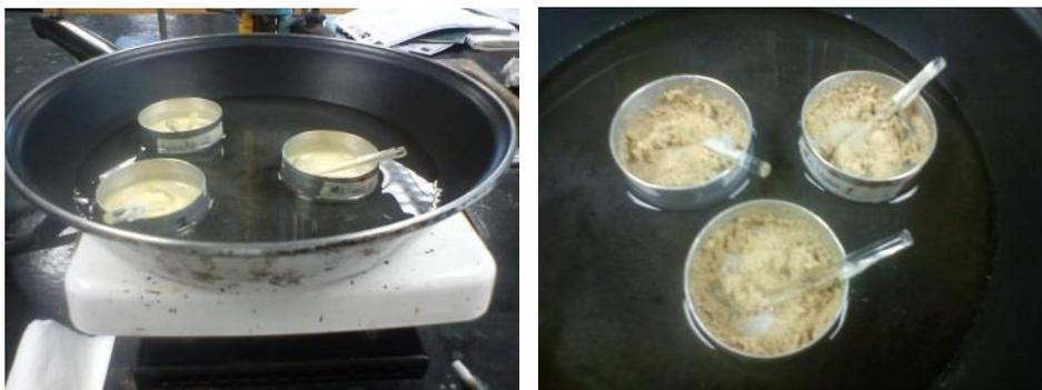
**Figura 38.** Baño maría para determinación de humedad
