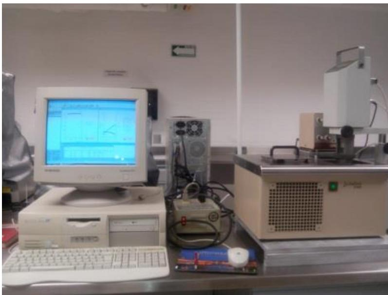
**Figura 35.** Viscosímetro de cilindros concéntricos.
