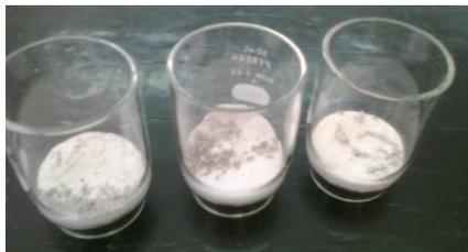
**Figura 50.** Cenizas de las muestras de fibra.
