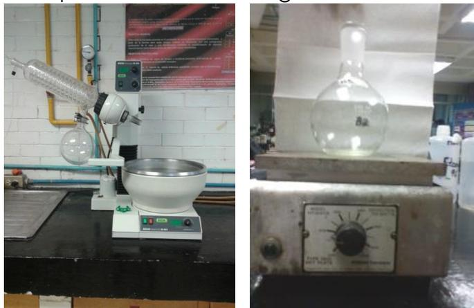
**Figura 40.** Evaporación de solventes en rotavapor y parrilla eléctrica.
