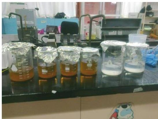
**Figura 49.** Muestras y blancos después de la adición de enzimas.
