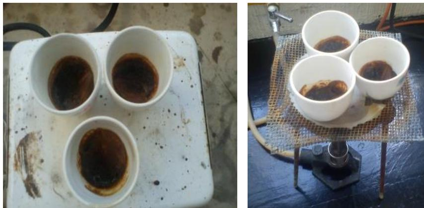
**Figura 47.** Incineración de muestras para cenizas.
