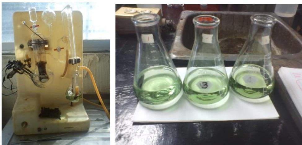
**Figura 42.** Destilador y muestras de helado destiladas.
