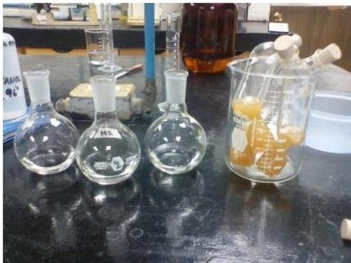
**Figura 39.** Muestras en reposo para extracción de grasa.
