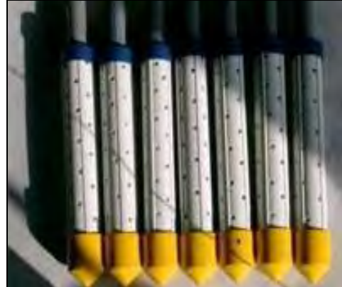
FIGURA 17. Cámara piezométrica y/o bulbo de línea (9) .
