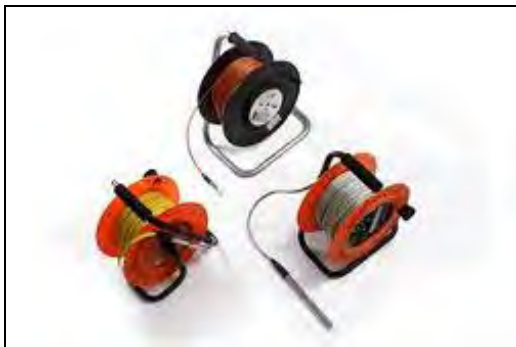
FIGURA 18. Sondas piezométricas (sondas electroacústicas y visuales) (10) .
