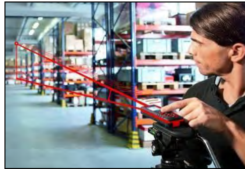
FIGURA 06. Ejemplo de medición con distanciómetro laser (4) .
