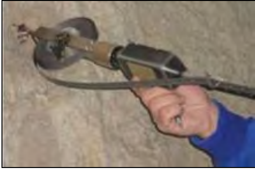
FIGURA 05. Medición de convergencias con extensómetro (3) .
