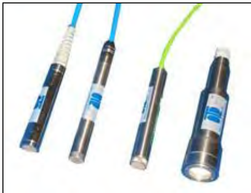
FIGURA 20. Piezómetros eléctricos y/o de cuerda vibrante (11) .
