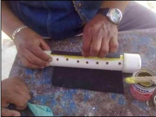
FOTOGRAFIA 05. Construcción de cámara piezométrica (bulbo de 50cm de longitud).
