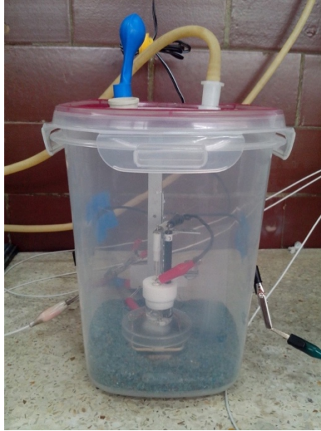
Figura 29. Montaje experimental empleado para controlar los niveles de humedad en la celda electroquímica durante los ensayos a largos periodos de análisis. Se utilizaron dos trampas de humedad conectadas en serie, un agitador magnético interno y conexiones selladas para evitar abrir el arreglo innecesariamente.
