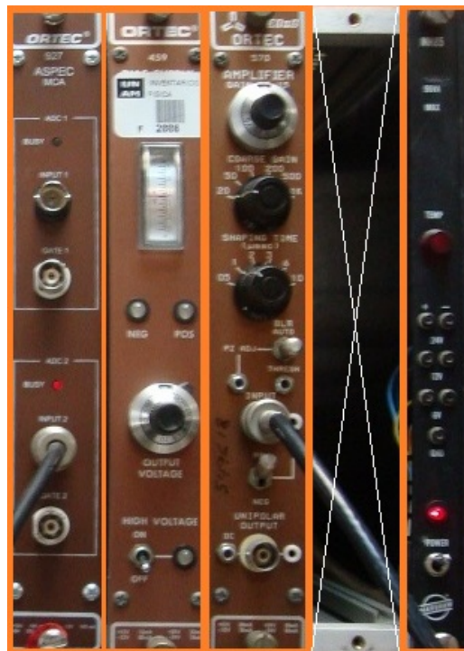
Figura 3.3: De izquierda a derecha, Analizador multicanal (MCA), Fuente de alto voltaje, Amplificador y Fuente de poder; electrónica del sistema de detección.
