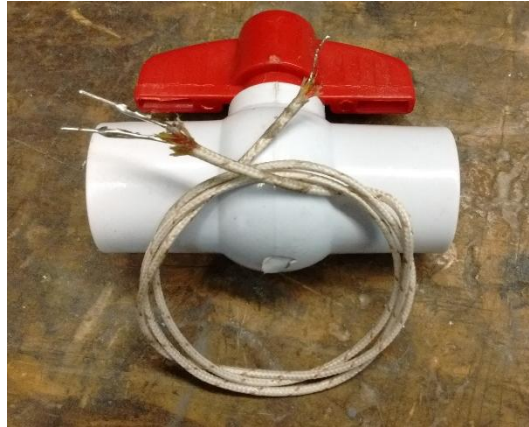
Figura 2.3. Termopar recién fabricado y válvula hidráulica nueva.
