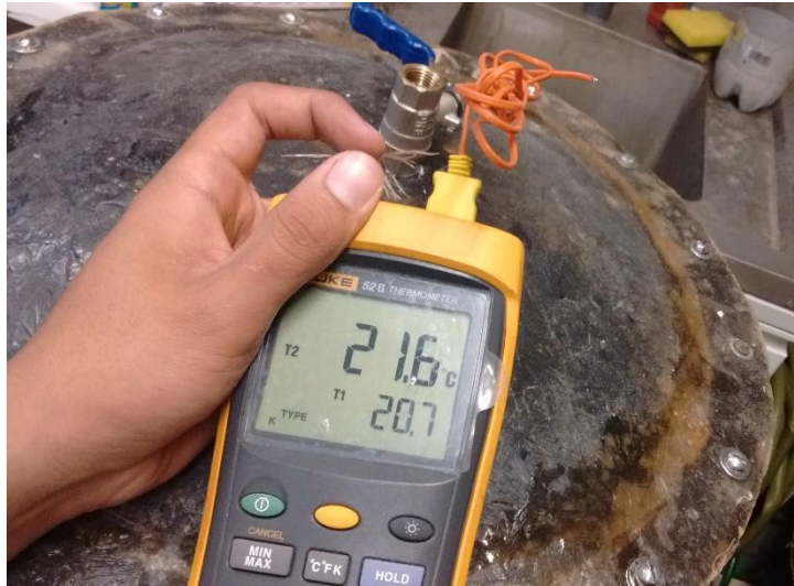
Figura 2.13. Medición de la temperatura ambiente y dentro del biodigestor.
