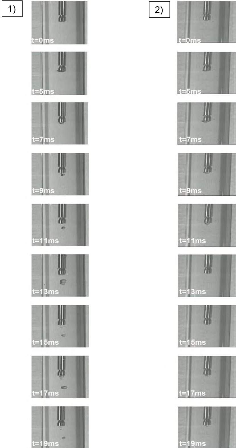
Figura 33. Se comparan dos secuencias fotográficas realizadas 1) fluido newtoniano y 2) con fluido no newtoniano (adelgazante), los dos experimentos a una misma carrera 'h' de 5.5 cm, en el fluido newtoniano (1) se logra desprender la burbuja de la punta, formando dos interfaces de tamaño pequeño, en el fluido adelgazante (2) no se logra desprender la burbuja de la punta ni logra crecer, únicamente viéndose el núcleo insertado en la muesca de la punta.
