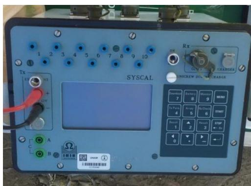
Figura 36. Equipo SySCAL para realizar el estudio de TRE.
