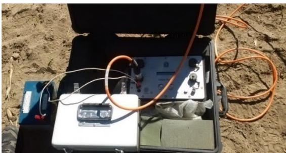
Figura 35. Batería, cables tipo caimán y conectores.
