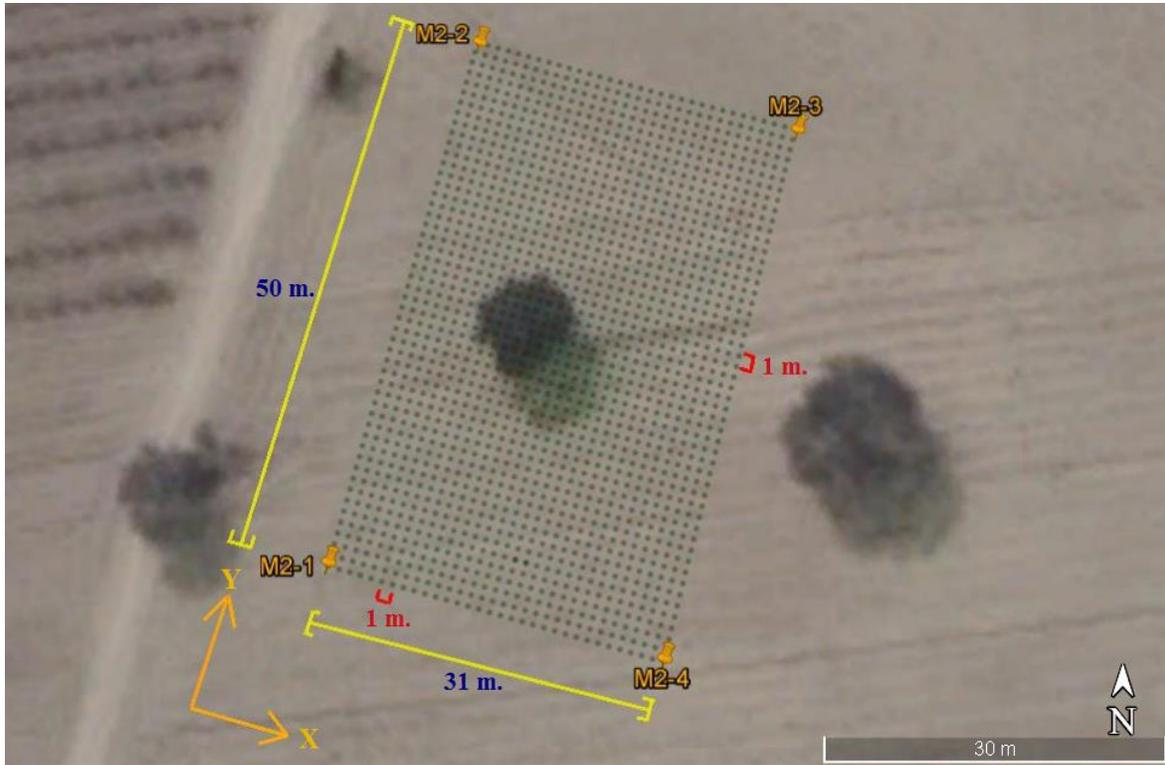
Figura 8. Visualización de los puntos de adquisición que conforman a la malla 2 en campo.
