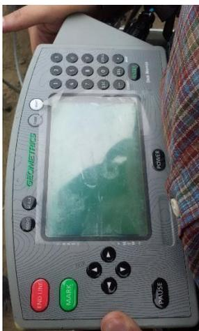
Figura 10. Magnetómetro G-858.
