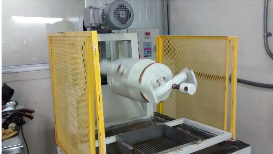
Figura 4.10 Molino de bolas del laboratorio metalúrgico Unidad Minera Sabinas.
