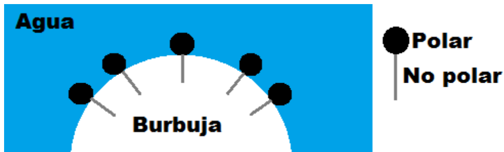
Figura 3.5 Estructura del funcionamiento de los espumantes
