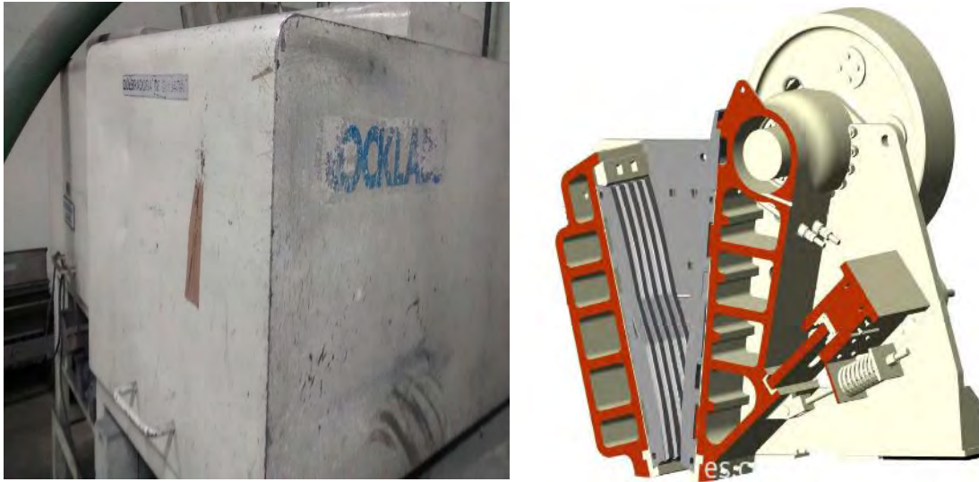
Figura 4.9 Quebradora de quijada del laboratorio metalúrgico Unidad Minera Sabinas.
