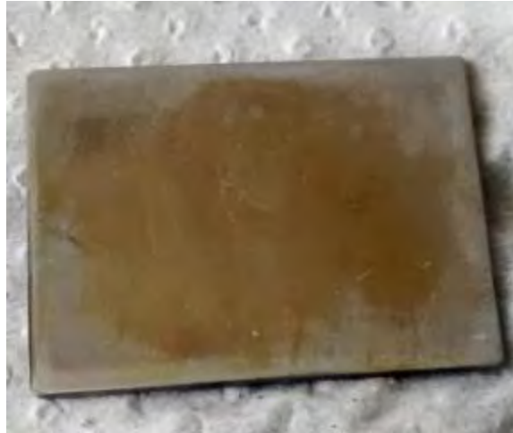
Figura 5.6 Cátodo de acero inoxidable con depósito de cobre.
