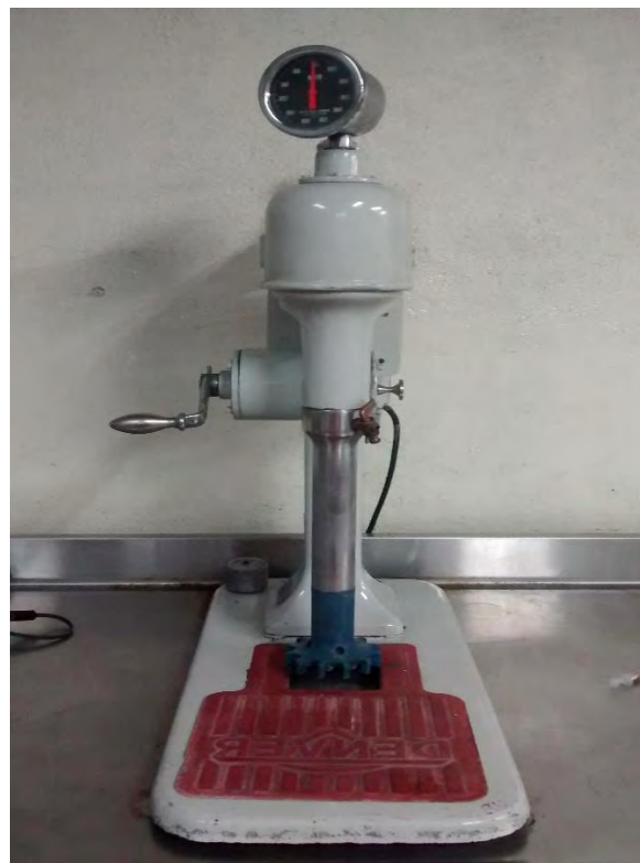
Figura 4.12 Equipo para pruebas de flotación Denver modelo 533000 tamaño D-12
