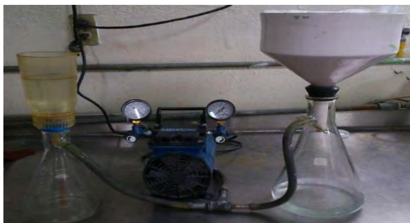
Figura 4.5 Equipo de filtración para preparación de agua para análisis químico y sólidos suspendidos.
