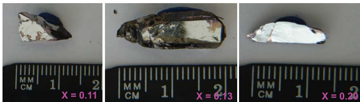
Figura 6.1: Imágenes de las muestras sintetizadas mediante reacción en estado sólido con atmósfera inerte de \text{Cu}_x\text{Bi}_2\text{Se}_3 con x = 0.11, 0.13 y 0.20 .
