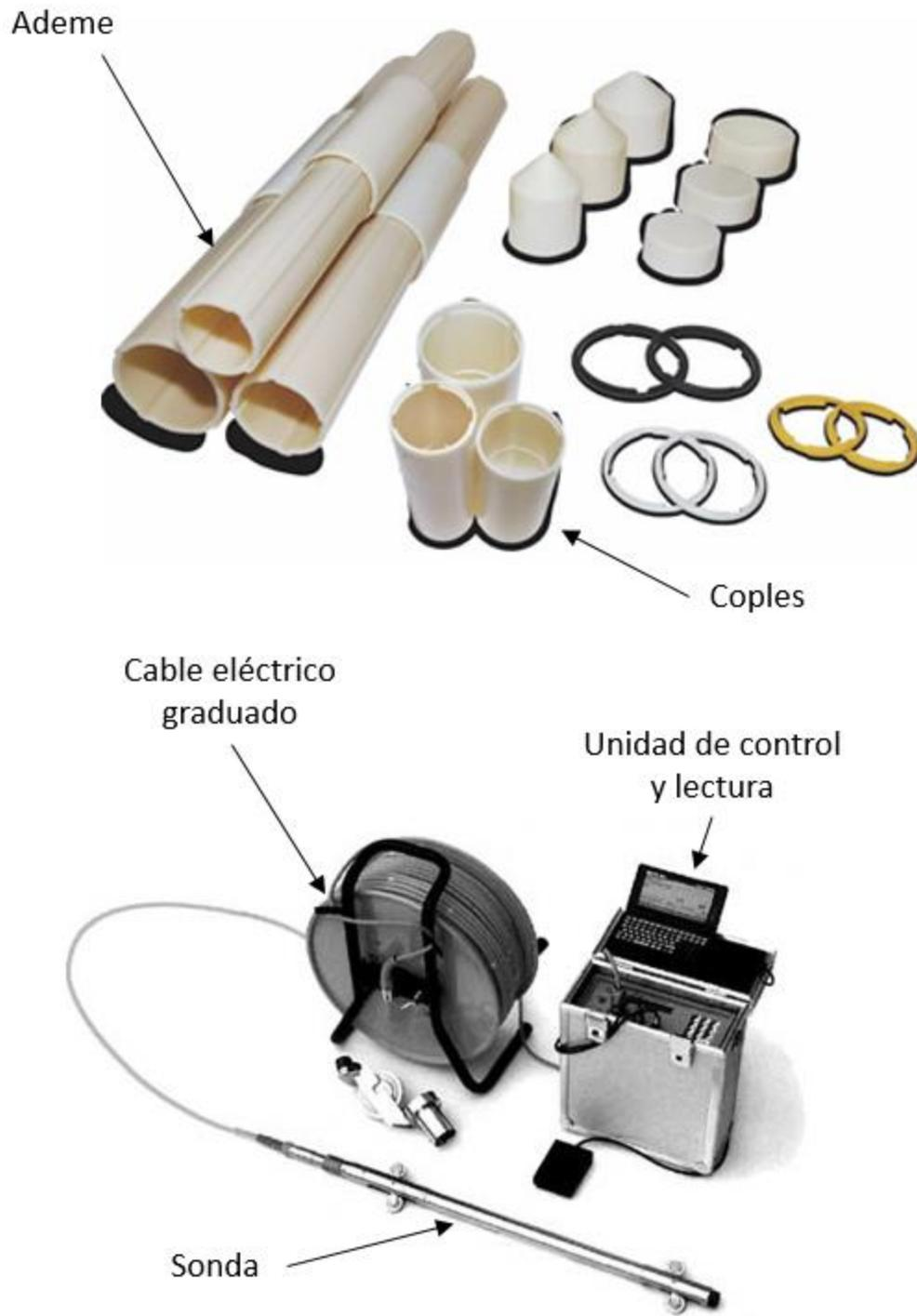
Figura 19. Elementos principales de un inclinómetro
