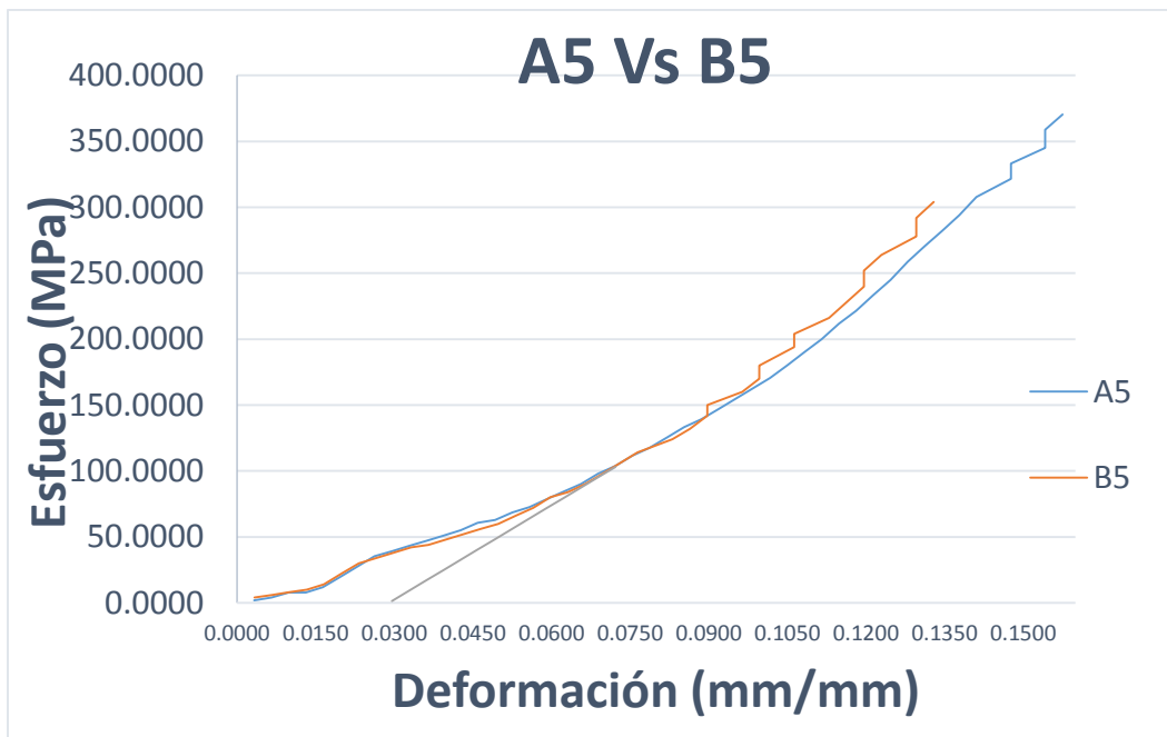
Figura 13. Comparación entre las curvas esfuerzo deformación para las piezas A5 y B5 para la segunda fusión.
