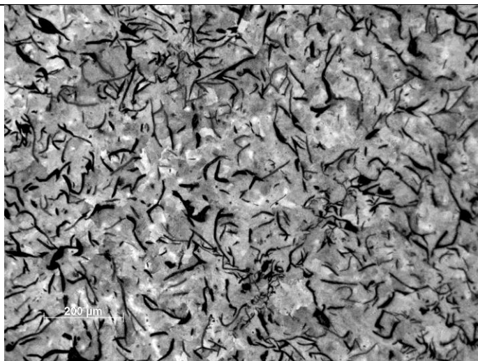
Figura 7 f. Micrografía "C1" 100X. Pieza fabricada por el Método C, Con ataque. Se puede ver una matriz completamente perlítica, sin embargo con estos aumentos no se puede distinguir la perlita fina de la gruesa.
