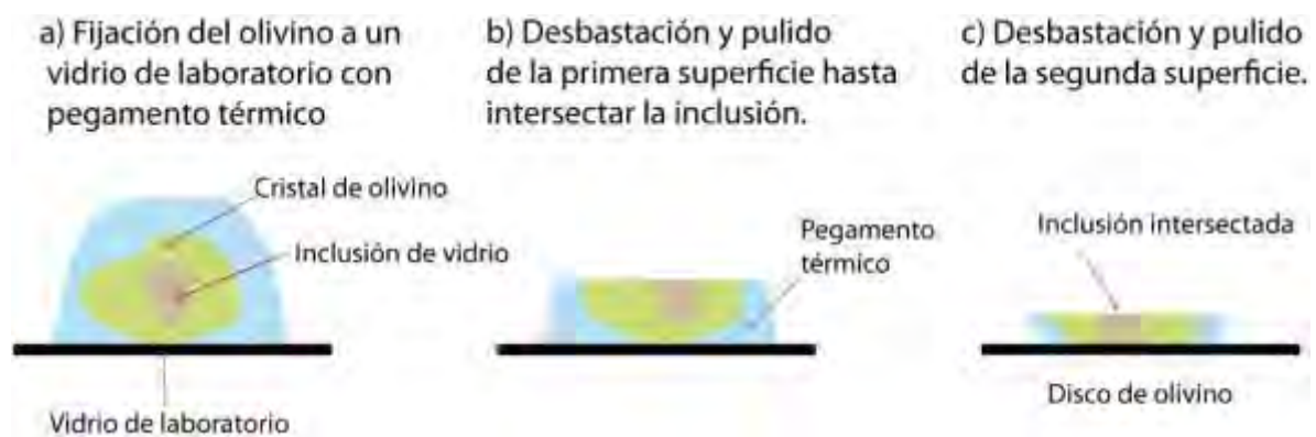
Figura 15. Etapas de preparación de los discos de olivino con inclusión de vidrio, (Roberge et al., 2005).
