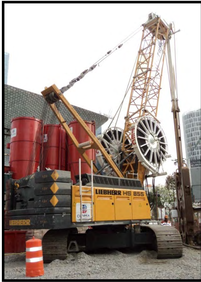
Ilustración 25. Grúa Liebherr 855HD u 853HD con almeja hidráulica BAYA.
