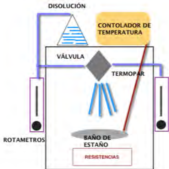
Figura 5: Esquema de la técnica de rociado pirolítico
