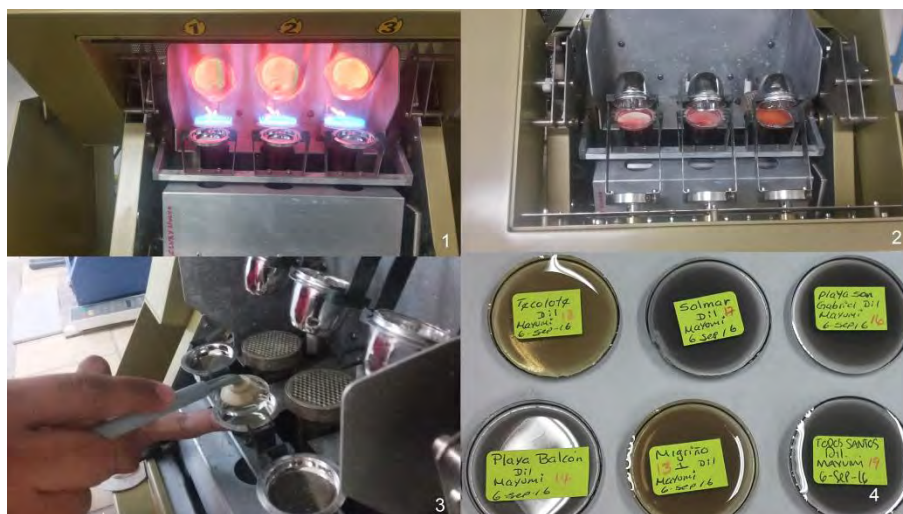
Figura 69. 1. Calentado de la muestra a 1100°C, 2. Vaciado de la muestra en recipientes de platino, 3. Se espera a que la muestra se enfríe para poder retirarla con ayuda de un chupón de goma. 4. Pastillas obtenidas.
