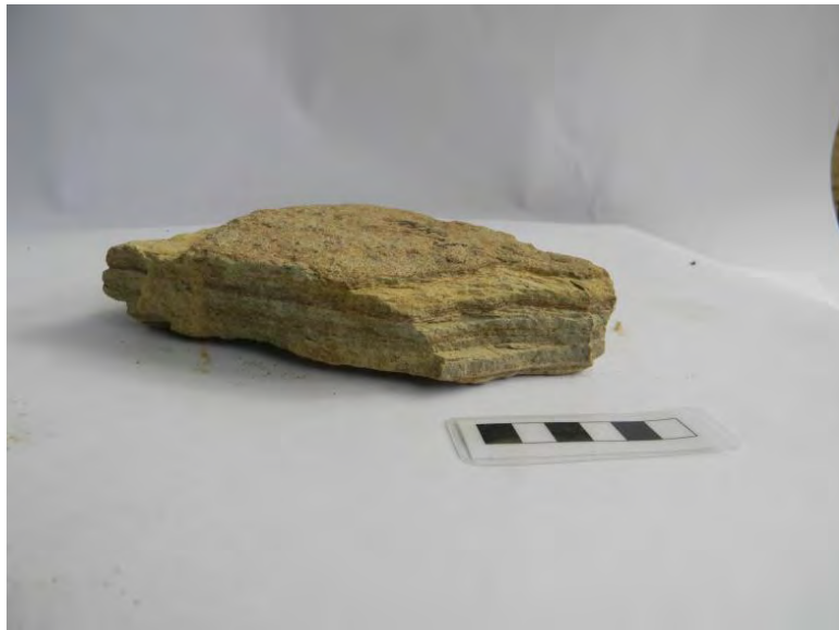
Figura 28. Se observan cristales de biotita, cuarzo y feldespato, el grado de compactación no es lo suficientemente alto así que la roca se desmorona con facilidad. Se observan planos de estratificación de 1 cm altamente carbonatados e intercalados con un horizonte de 3mm de color más oscuro, menor mineralización y no reaccionan al contacto con el ácido clorhídrico (diluido al 10%). Nombre de la roca: arcosa.
