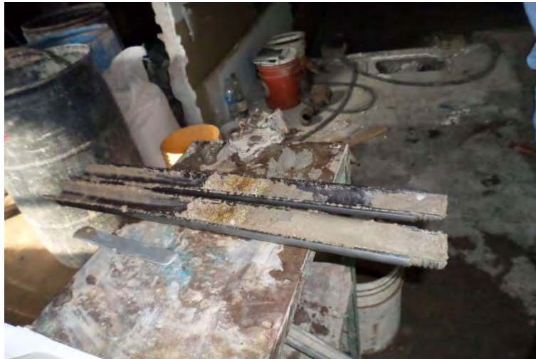
FOTOGRAFÍA 10. MUESTRA EXTRAIDA POR TUBO PARTIDO
