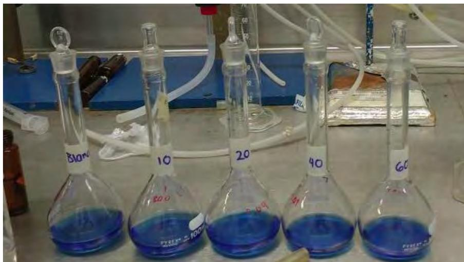
Fig. 10 Matracas volumétricos con solución Índigo (método colorimétrico del Índigo).
