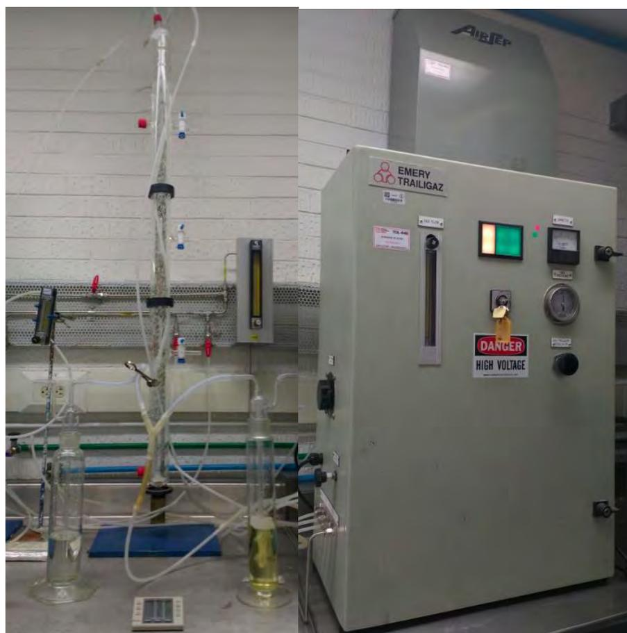
*Fig. 8 Izquierda, columna de burbujeo en operación y los dos lavadores conectados (método yodométrico). Derecha, generador de ozono EMERY TRAILIGAZ LABO 76 y separador AIRSEP.*
