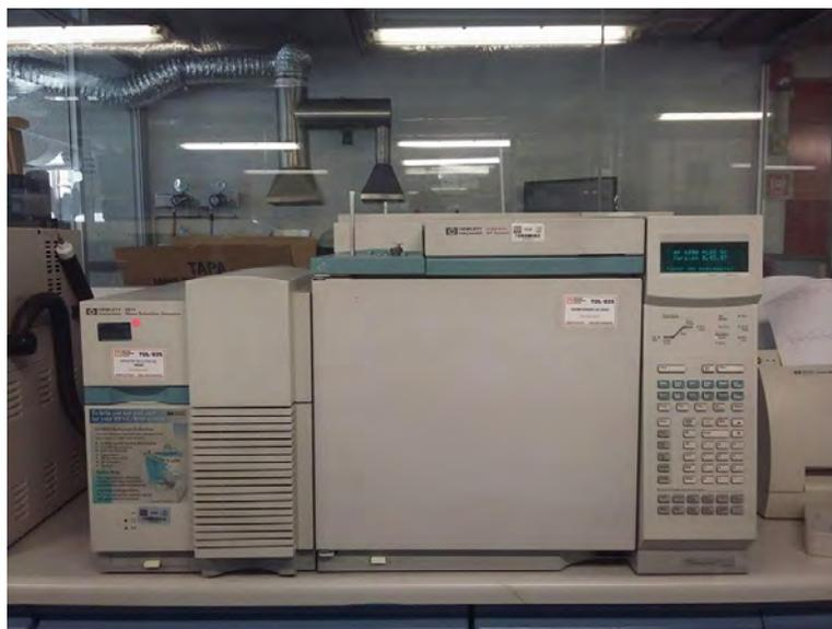
*Fig. 15 Cromatógrafo de gases con espectrómetro de masas usado.*
