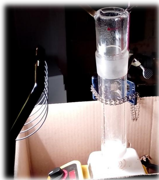
Fig. 6.26: Uso de refrigeración para mantener a temperatura constante (aprox. 20°C) la muestra de Cipro catalizada con TiO 2 bajo luz visible.
