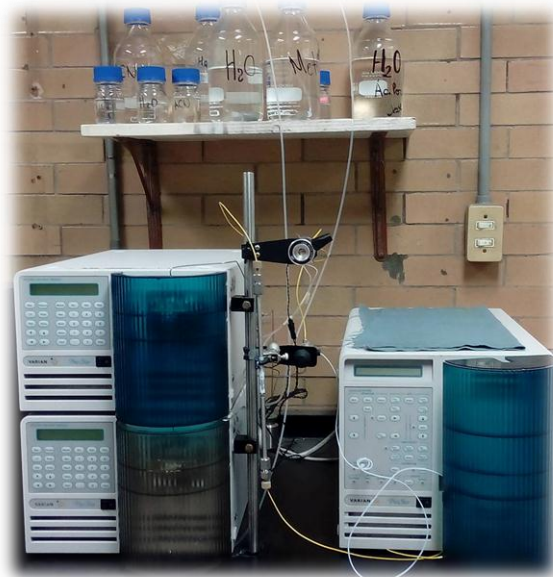
Fig. 5.2: Equipo HPLC para identificar intermediarios de la degradación de ciprofloxacino.
