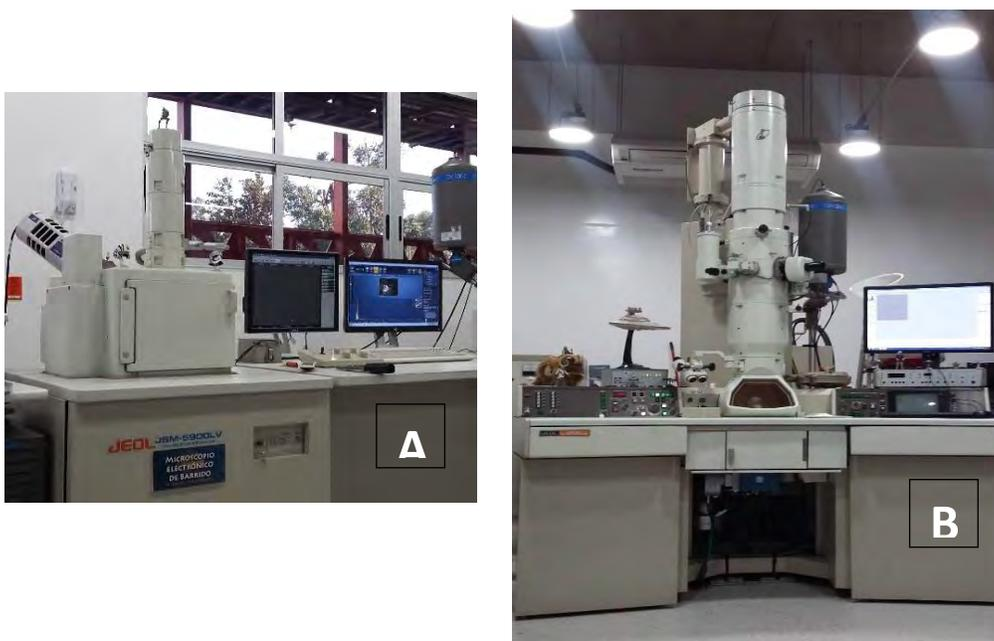
*Figura 14. Microscopio electrónico de A) barrido y B) transmisión utilizados para la realización de este trabajo (USAI, 2016).*
