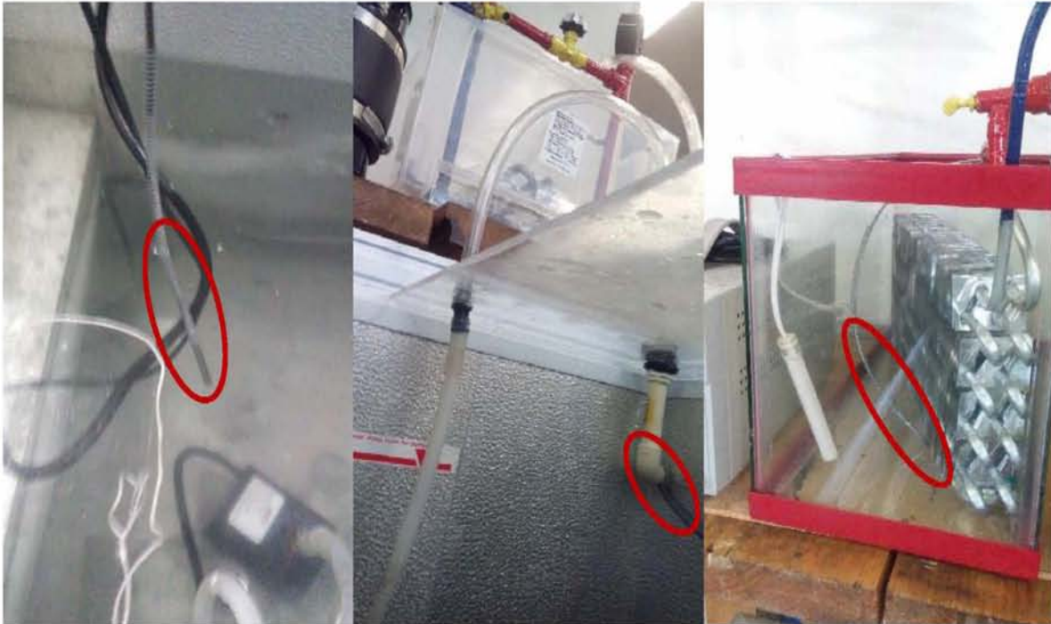
Figura 3.9 Termopar tipo J dentro del congelador (izquierda), termopar tipo J en el retorno de agua al congelador (centro), termopar tipo J en la zona del evaporador (derecha).
