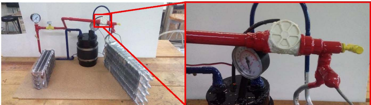
Figura 3.21 Flujómetro a la salida del evaporador.
