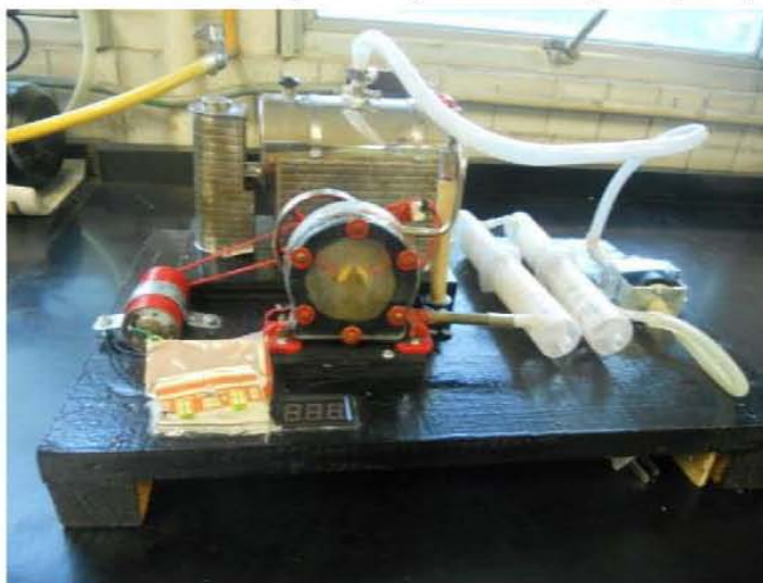
Figura 3.1 Primer prototipo de planta OTEC de laboratorio para este proyecto.
