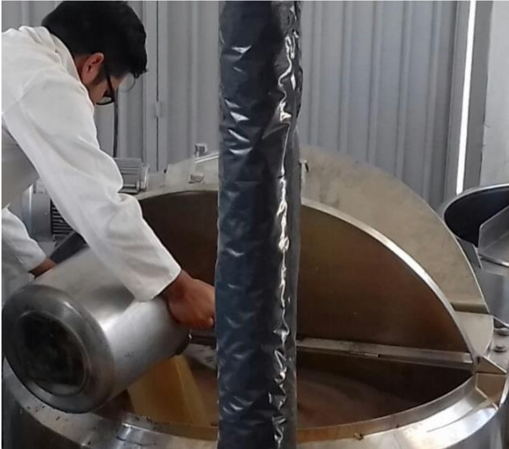
Figura 10. Inoculación del reactor con el 10% v/p de L. brevis , en 250 kg de camarón con 10% p/p de azúcar, con temperatura de 30°C.
