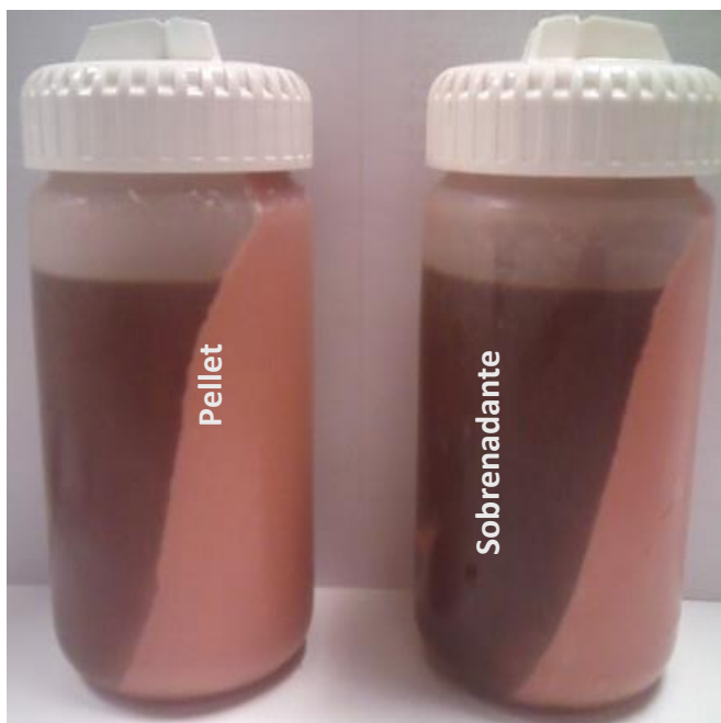
Figura 7. Pellet y sobrenadante, resultado de la centrifugación de la fracción rica en proteína en Centrifuga Beckman Coulter en un rotor J2-MC, a 14,000 rpm durante 20 minutos a 4°C.
