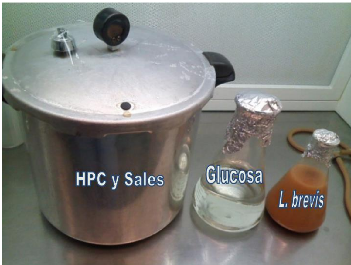
Figura 9. HPC, sales y glucosa del medio MRS, esterilizados a 121°C, 1 atm, 15 min; e inóculo de L. brevis incubado a 30°C durante 24 h. (Previos a la preparación del inóculo).
