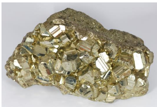
Figura 15. Muestra de mano Pirita de alta pureza utilizada para las pruebas de Potencial Zeta
