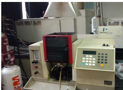
Figura 17. Equipo de Espectroscopía de Absorción Atómica, Pekín Elmer 3100
