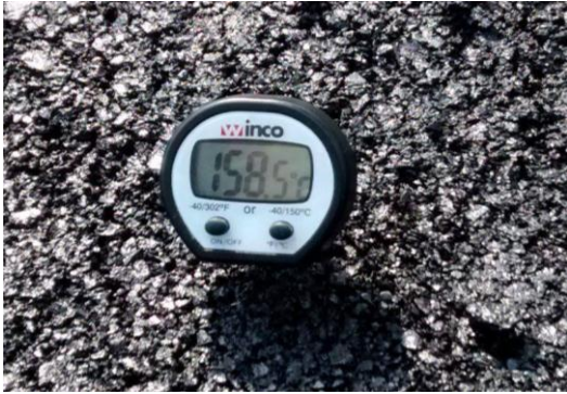
Imagen 21. Pruebas de temperatura. Imagen 22. Colocación de carpeta asfáltica.
