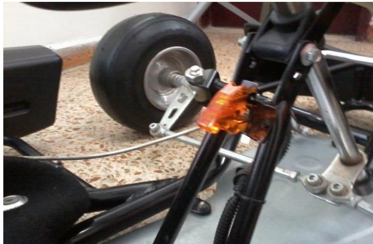
Fig. 4.12 Colocación de *switch* de encendido.
