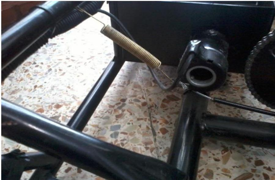
Fig. 4.10 Colocación de resorte metálico a puño del acelerador.
