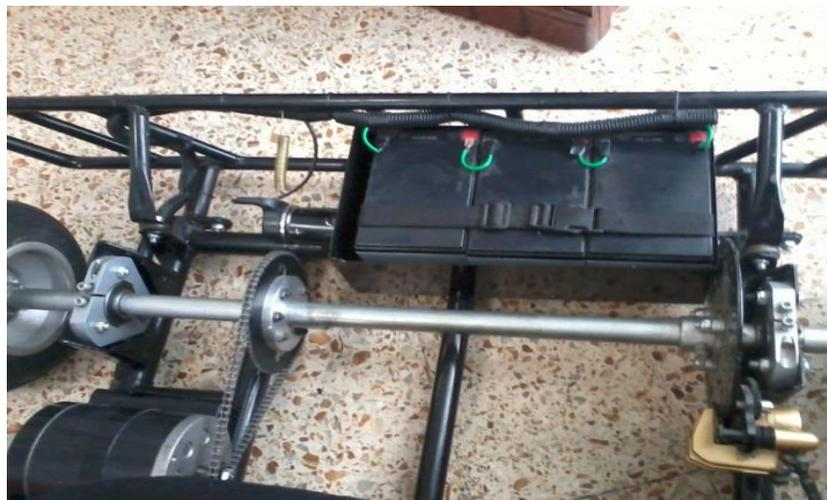
Fig. 4.9 Colocación de baterías.
