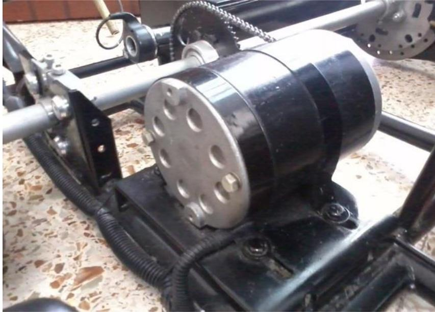
Fig. 4.8 Fijación de motor eléctrico al chasis.
