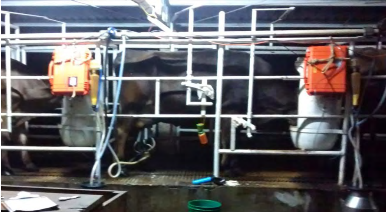
Figura 4 Toma de muestra de la atmosfera del comedero en la unidad de producción “Establo 7” del sistema Lechería Familiar, mostrando los sensores Guardian Plus.
