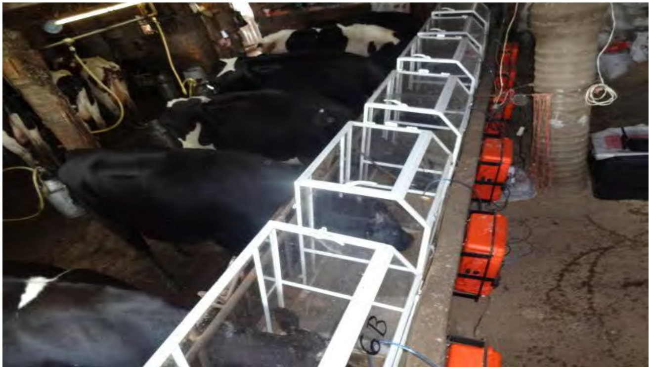
Figura 2. Toma de muestra de la atmosfera del comedero en la unidad de producción “Establo 7” del sistema Lechería Familiar, mostrando los sensores Guardian Plus.
