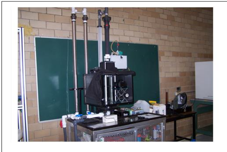
Fig. 2.9-3 Montaje de una cámara oscura para la visualización de vórtices.
