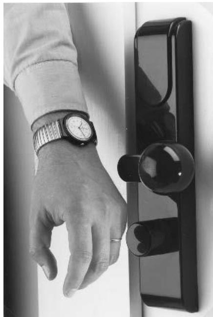
Fig. 3.9 Reloj con un Tag integrado para los Sistemas de Autorización de Acceso Contactless. [Propiedad de Junghans Uhren GmbH, Schramberg] [8]
