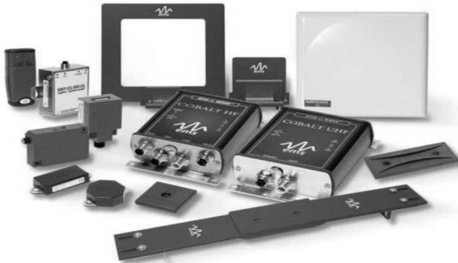
Fig. 3.14 Sistema completo RFID [Propiedad de Datalogic] [8]
