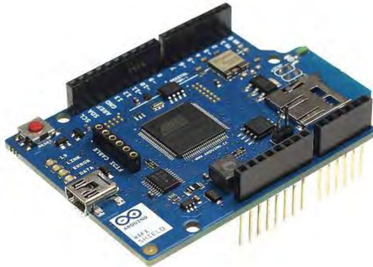
El Arduino Wi-Fi Shield es una placa de adaptación del módulo Wi-Fi WIZ610wi de WIZnet. Éste shield da conectividad inalámbrica a una red Wi-Fi con o sin salida a internet, es compatible con las plataformas Duamilanove, Mega y Uno. El módulo Wi-Fi WIZ610wi posee el stack TCP/IP por hardware lo que lo hace ser una de las plataformas más estables del mercado, sin necesidad de ocupar recursos del procesador o microcontrolador en tareas de comunicación. [G]
