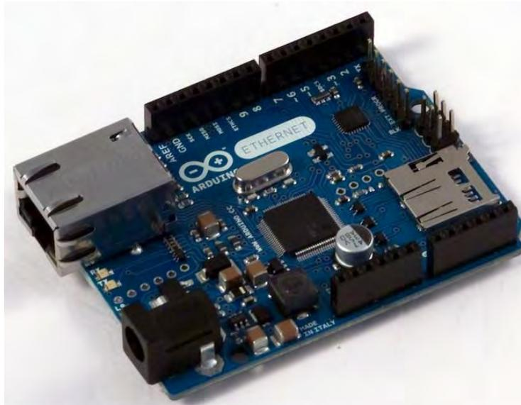
El Arduino Ethernet es una placa con un microcontrolador ATmega328. Tiene 14 terminales input/output, 6 entradas analógicas, un oscilador de cristal a 16 MHz, entrada para un conector RJ45, un jack de alimentación, un header ICSP y un botón de reset. [G]
