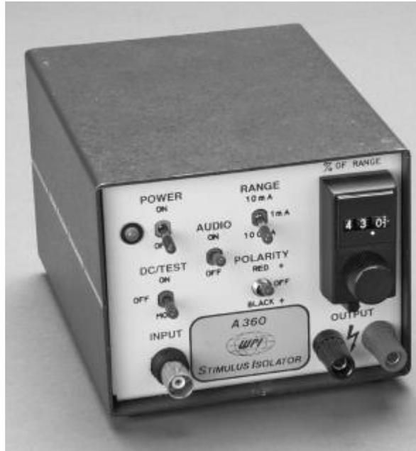
**Figura 4.1.** Electro-estimulador comercial A360LA de *World Precision Instruments Inc.* USA.
