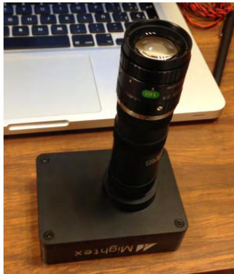
**Figura 3.15.** Cámara Mightex™ con macroscopio.
