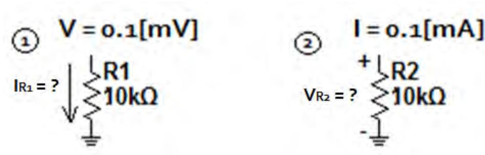
Figura 1.4. Comparación al aplicar voltaje y corriente.
